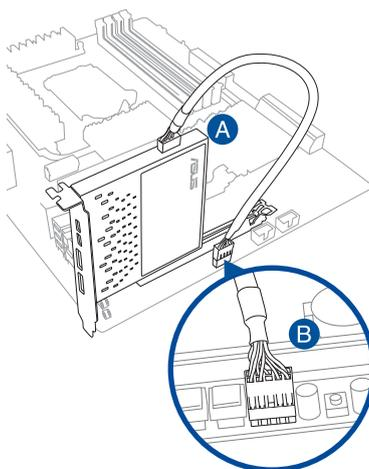
5. 付属のDisplayPort / Mini DisplayPort ケーブルを使用して、下図のように本製品とマザーボードのDisplayPort / Mini DisplayPort を接続します。
