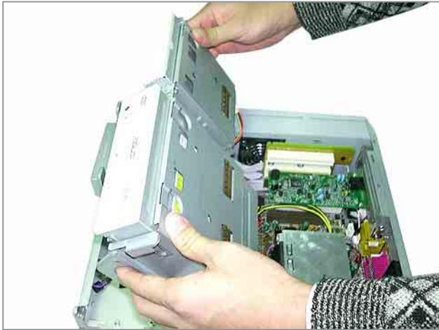
2. 自機殼取下整個光碟機及軟碟機模組。
