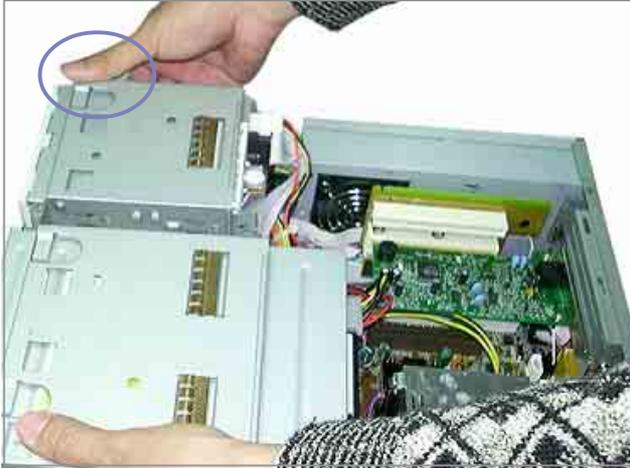
1. 用雙手緊握住光碟機 / 軟碟機模組的二側，並用右手大拇指按住機殼右端邊緣處的卡榫，即可鬆開模組。
