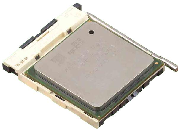
8. 當處理器安置妥當，接下來在您要拉下固定拉桿欲鎖上處理器插槽的同時，請用手指輕輕地抵住處理器。最後當固定拉桿鎖上插槽時會發出一清脆聲響，即表示已完成鎖定。
