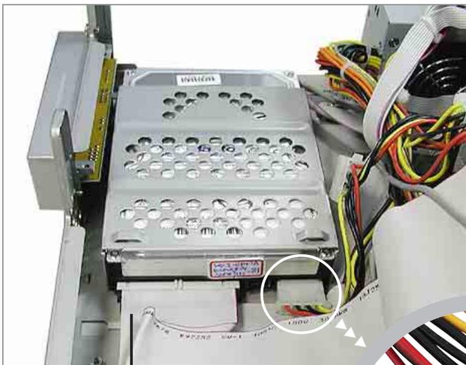
2. 接下來將硬碟模組裝回機殼中，並連接好 IDE 排線及電源線（P3）。
