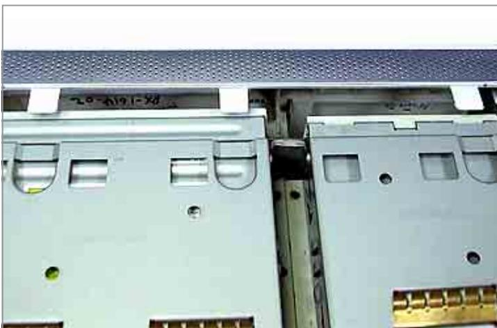
4. 重新裝回系統前端面板，注意需將三個卡榫固定在適當的位置。
