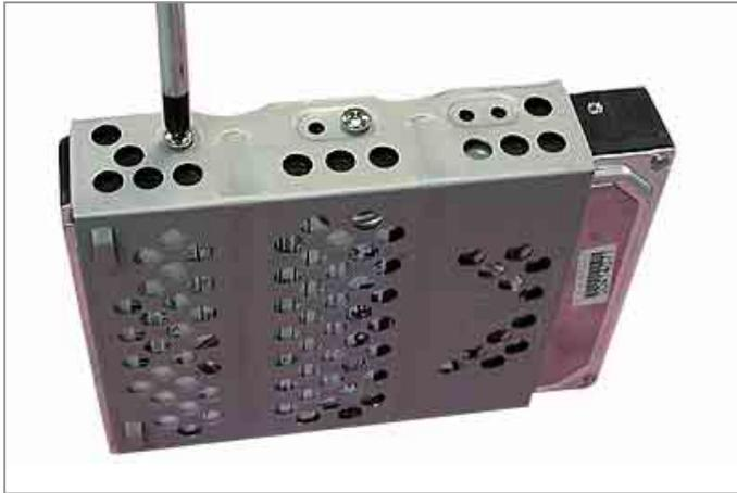
1. 小心地將硬碟插入硬碟模組槽中，並對準螺絲孔，然後用四顆螺絲鎖緊（每邊二顆）。
