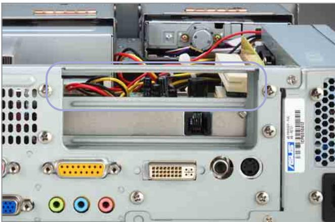
2. 當您移除機殼上的金屬擋板之後，即可安插所需的介面卡。
