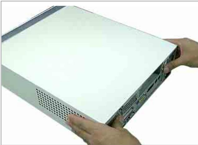
2. 將雙手的大拇指分別放在機身後端的面板上，然後用其餘的手指頭將機殼從前端往後端推出，以使機殼與機身分離。
