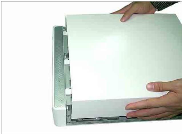
6. 將機殼上蓋裝回機殼中，注意內部的卡榫是否都已裝置妥當，並與機身完全吻合，最後記得鎖上之前拆下的兩螺絲，以完全固定機殼。
