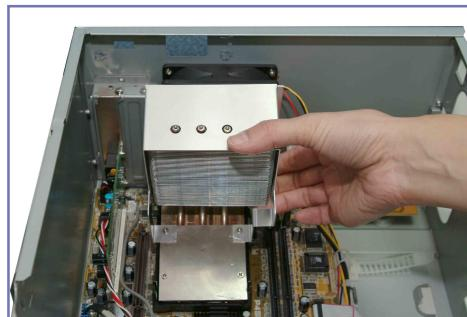
2. 接下來請將固定夾二邊的鉤扣小心地鉤住「支撐機構底座」上的孔。
