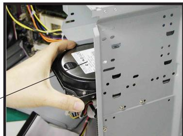
3. 小心地將硬碟機推入插槽中，直到硬碟機的螺絲孔對準機身上面的螺絲孔。
