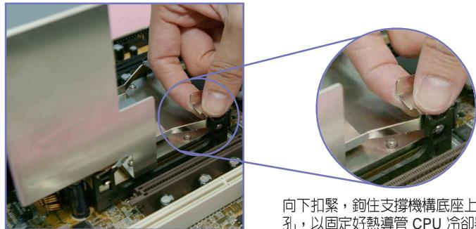
向下扣緊，鉤住支撐機構底座上的孔，以固定好熱導管 CPU 寶卻器
