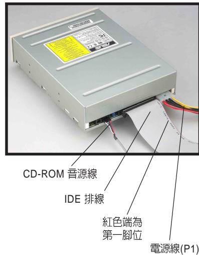
6. 將 IDE 排線的一端連接在光碟機後端的 IDE 排線插座上，注意排線的紅色端為第一腳位。
