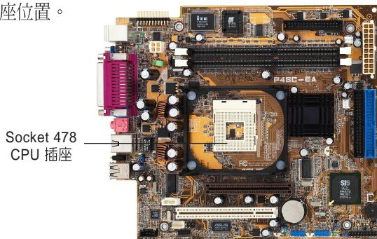
2. 請將 CPU 插座的固定板手扳起成 90-100 度。
