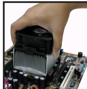
2. 接下來請將二個固定桿小心地鉤住「支撐機構底座」上的孔。
