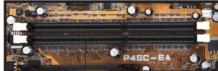
DDR DIMM 插槽
