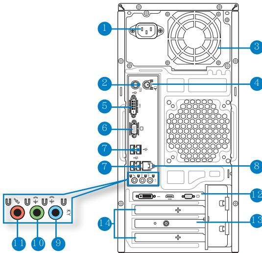
1. 電源插槽：將電源排線連接至此插槽。（電源：115V~220-230V~, 6A/4A , 60/50Hz）
