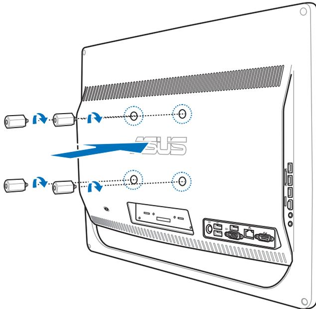
5. 将 All-in-one 计算机 配合锁上的壁挂螺丝装入已经装好壁挂套件（面板与支撑架）的坚固墙面上，请按照您所使用的壁挂套件所附的用户手册说明操作。
