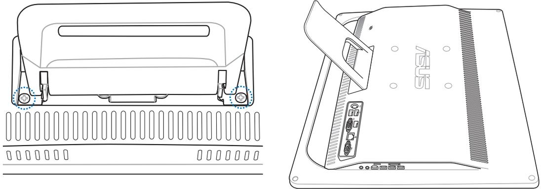
2. 卸除支撑脚架，如下图所示，用手握住支撑脚架并向下压（1），然后向前推将支撑脚架松脱后（2）再向上取出（3），并置于一旁。
