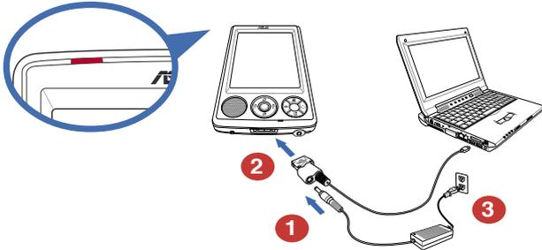
**NOTE** La LED de statut de la charge batterie s'allume en rouge lorsque la batterie est en cours de chargement et en vert lorsque celle-ci est pleine.
