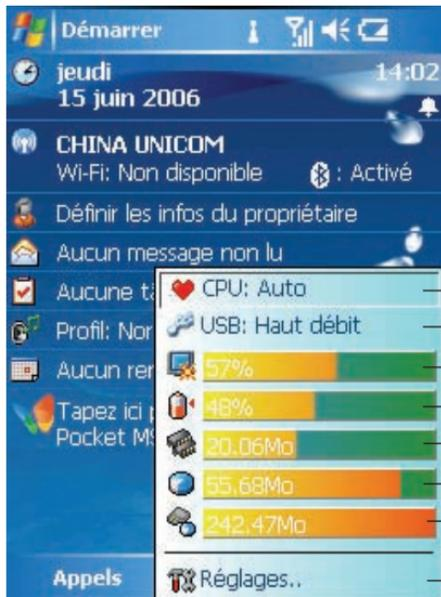
**CPU:** Permet de régler le mode CPU. Sur Mode automatique la vitesse du CPU est ajustée en accord avec la charge système.
