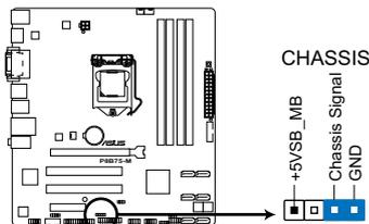
Connecteur d'intrusion châssis de la P8B75-M
