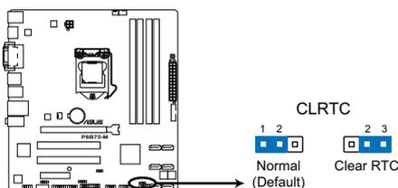
Jumper d'effacement de la mémoire RTC de la P8B75-M
