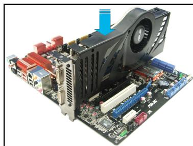
4. 對齊且緊密地將 SLI 橋接裝置插入二張顯示卡的金手指位置，並確認橋接裝置已經緊密的插入在正確的位置。
