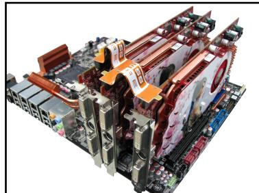
5. 將三條電源線分別從電源供應器連接至三張顯示卡的電源插座上。
