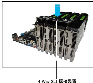
4. 對齊且緊密地將 4-Way SLI 橋接裝置插入每張顯示卡的金手指位置，並確認橋接裝置已經緊密的插入在正確的位置。
