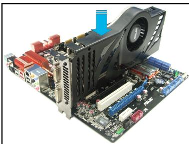
4. 對齊且緊密地將 3-Way SLI 橋接裝置插入每張顯示卡的金手指位置，並確認橋接裝置已經緊密的插入在正確的位置。
