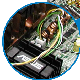
CPU2 風扇電源連接線 (CPU_FAN2)
