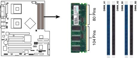
PCH-DL 184-Pin DDR DIMM Sockets
