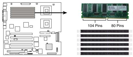
PR-DLS 184-Pin DDR DIMM Sockets
