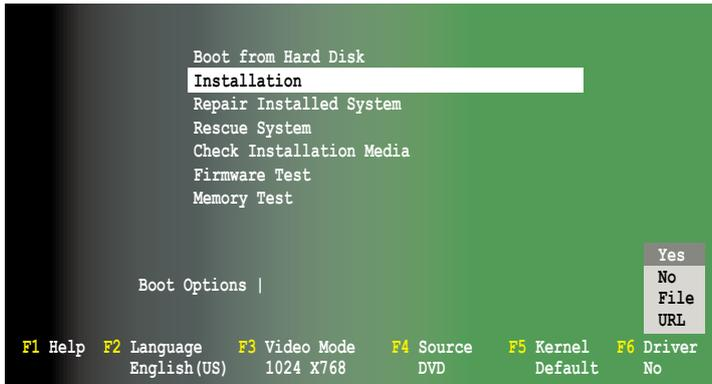
4. 当出现交谈框时，请在软驱中放入 RAID 驱动程序软盘，并在 Boot Option 栏位中输入 `acpi=off apic=bigsmc brokenmodules=ahci`，然后按下 `<Enter>` 键。
