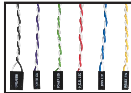
指示灯号与开关按钮的数据线
