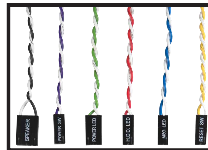
Przewody LED i wyłącznika
