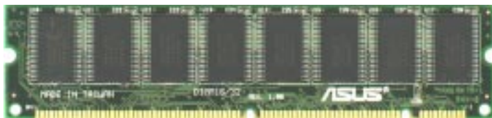
SDRAM DIMM-память без контроля четности (8 микросхем)
