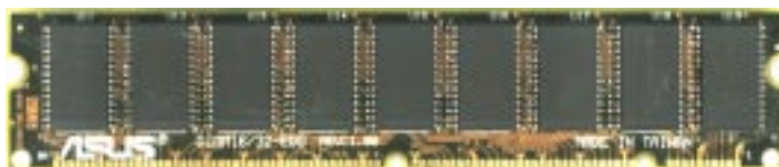
EDO DIMM-память с контролем четности (9 микросхем)
