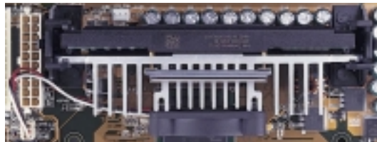
上覆散热片与风扇、安装在单边接触 CPU 插槽中的 SECC2 包装 Pentium® II 处理器或是 SEPP 包装的 Celeron™ 处理器 (俯视图)
