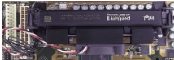
上覆散热片与风扇、安装在单边接触 CPU 插槽中的 SECC 包装 Pentium® II 处理器 (俯视图)
