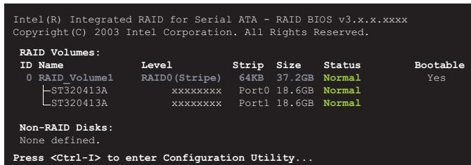
6. 磁碟陣列建構完成後，可使用 FDISK 程式或是作業系統內建程式將此磁碟陣列格式化即可使用。
