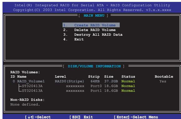
5. 按下 [ESC] 鍵來離開本程式，重新開機後，Intel® RAID BIOS 會檢查並且顯示目前系統內的磁碟陣列模式與狀態。
