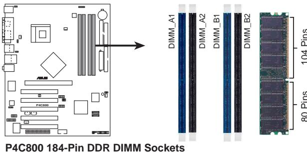
本主機板依照不同的 CPU 前側匯流排 (Front Side Bus, FSB) 與 DDR 記憶體形式，支援不同的記憶體頻率。
