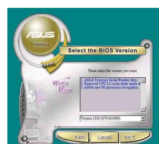
如果您選擇要直接以檔案來更新 BIOS 程式，那麼您必須要在如右圖所示的視窗中找到該檔案的存放位置。最後再跟著畫面上的指示完成 BIOS 更新的程序。
