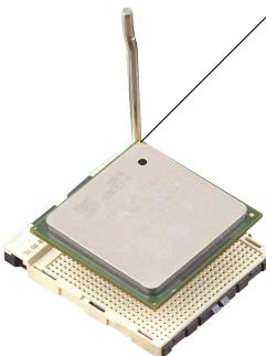
5. 當處理器安置妥當，接下來在您要拉下固定拉桿欲鎖上處理器插槽的同時，請用手指輕輕地抵住處理器。最後當固定拉桿鎖上插槽時會發出一清脆聲響，即表示已完成鎖定。
