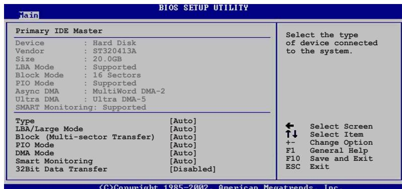
在畫面中出現的各個欄位的數值以淡灰色顯示，皆為 BIOS 程式自動偵測裝置而得。若欄位顯示為 N/A，代表沒有裝置連接於此通道裝置。
