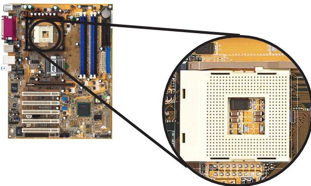
2. 將 Socket-478 插座側邊的固定拉桿拉起至其角度幾與插座呈 90 度角。
