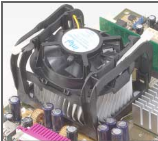
Рисунок 2-11 Вентилятор и крепёжный механизм в установленном и закреплённом положении
