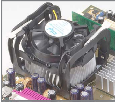
圖示 2-11 風扇和支撐機構的安裝與鎖定
