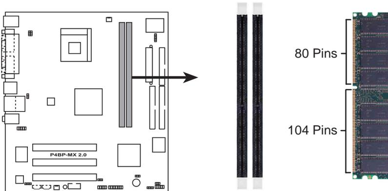
**P4BP-MX 2.0 184-Pin DDR DIMM Sockets**
