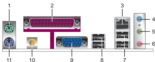
1. PS/2 鼠标连接端口 (绿色)：将 PS/2 鼠标插头连接到此端口。
