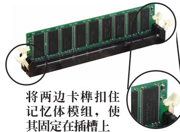
将两边卡榫扣住记忆体模组，使其固定在插槽上
