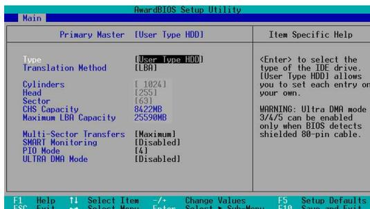
您可以自行输入磁柱 (Cylinder) 数目、读写磁头 (Head) 数目以及硬盘每一碟轨的磁扇 (Sector) 数目。您可以阅读硬盘的使用文件或直接查看硬盘上的标签贴纸来获得上述数值。
