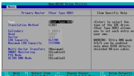
您可以自行輸入磁柱 (Cylinder) 數目、讀寫頭 (Head) 數目以及硬碟每一碟軌的磁扇 (Sector) 數目。您可以閱讀硬碟的使用文件或直接查看硬碟上的標籤貼紙來獲得上述數值。
