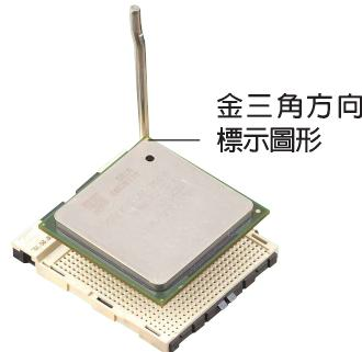
5. 當處理器安置妥當，接下來在您要拉下固定拉桿欲鎖上處理器插槽的同時，請用手指輕輕地抵住處理器。最後當固定拉桿鎖上插槽時會發出一清脆聲響，即表示已完成鎖定。
