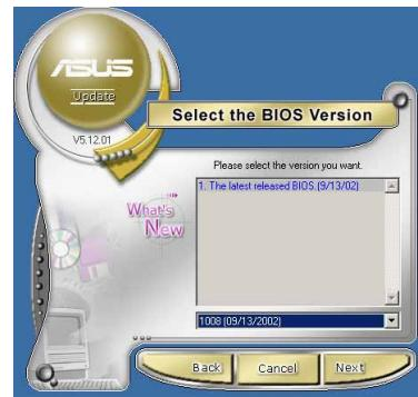
如果您選擇要直接以檔案來更新 BIOS 程式，那麼您必須要在如右圖所示的視窗中找到該檔案的存放位置。最後再跟著畫面上的指示完成 BIOS 更新的程序。
