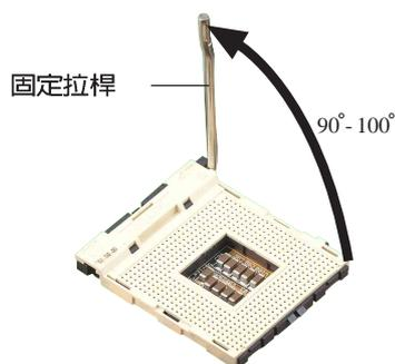
3. 將 Pentium® 4 處理器標示有金三角的那一端對齊固定拉桿的底部（與處理器插座連接的地方，見右圖所示）。
