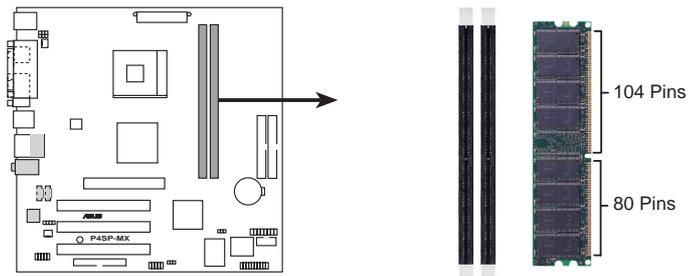
**P4SP-MX 184-Pin DDR DIMM Sockets**
