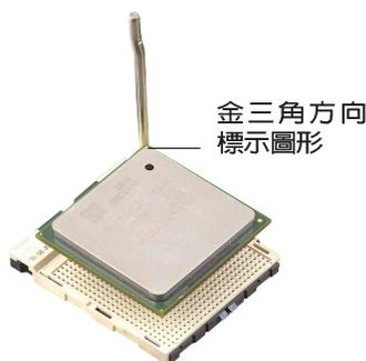
5. 當處理器安置妥當，接下來在您要拉下固定拉桿欲鎖上處理器插槽的同時，請用手指輕輕地抵住處理器。最後當固定拉桿鎖上插槽時會發出一清脆聲響，即表示已完成鎖定。
