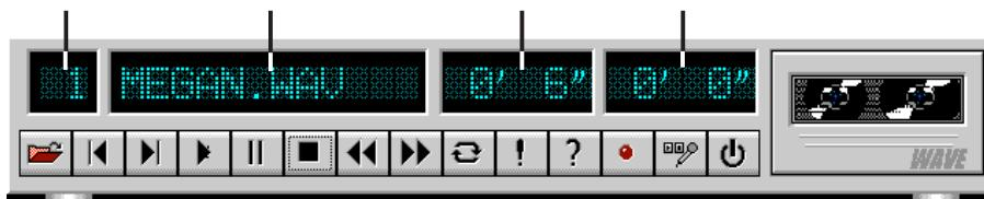
**WAV 播放程式** 可以讓您做 .WAV 檔的線性 PCM (8 或 16 位元) 的聲音錄製選擇、播放以及壓縮動作，也可以讓您播放 .AUD 檔。其中 .WAV 檔是用 Windows 的 PCM 聲音規格，而 .AUD 則是使用 ESPCM 噓壓縮格式所產生的聲音檔。您可以將聲音直接錄到硬碟中，只要您的硬碟有多大，聲音檔舊可以錄到多大。
