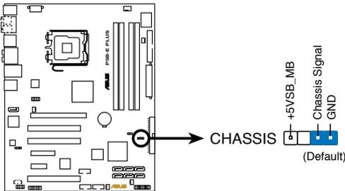
Connecteur Châssis intrusion de la Série P5B Premium
