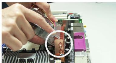
2. Faites correspondre le bord rainuré avec le dissipateur.
