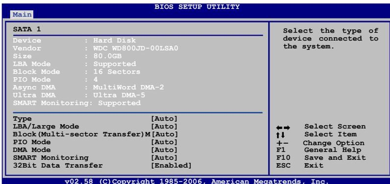
Les valeurs sises aux éléments grisés (Device, Vendor, Size, LBA Mode, Block Mode, PIO Mode, Async DMA, Ultra DMA, and SMART monitoring) sont auto-détectées par le BIOS et ne sont pas configurables. Ces éléments apparaissent N/A si aucun périphérique IDE n'est installé sur le système.
