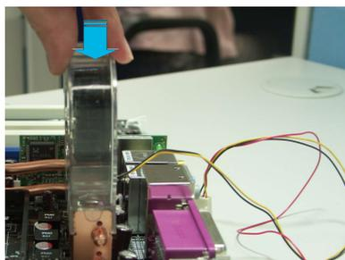
3. Enfoncez délicatement le ventilateur jusqu'à ce qu'il soit bien en place sur le dissipateur, puis connectez les câbles du ventilateur.
