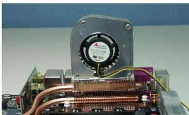
N'installez pas le ventilateur avec l'arrière vous faisant face.
