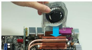
1. Placez le ventilateur sur l'ensemble tuyau-dissipateur.
