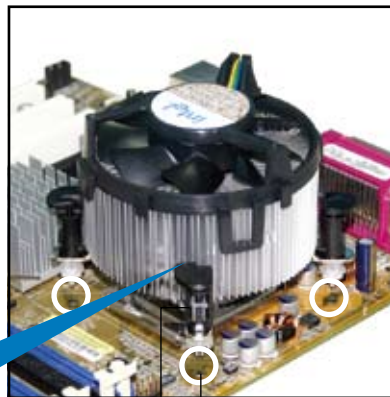
Loch am Motherboard Druckstift
