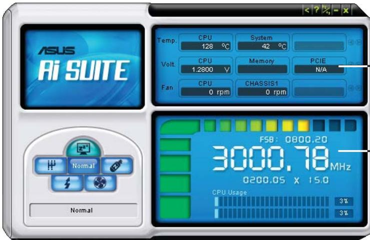
Zeigt die CPU-/System-temperatur, CPU-/Arbeitsspeicher-/PCIE-Spannung und CPU-/Gehäuselüftergeschwindigkeit an.
