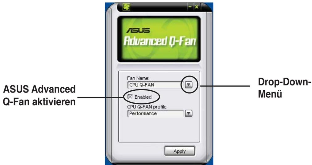
Nach dem Klick auf **Enable Q-Fan** erscheint die Profile-Liste. Klicken Sie auf die Drop-Down-Listenschaltfläche und wählen Sie ein Profil. Der **Optimal**-Modus regelt die Drehzahl entsprechend der Temperatur, der **Silent**-Modus minimiert die Lüfterdrehzahl für einen leisen Betrieb und der **Performance**-Modus erhöht die Drehzahl auf das Maximum, um die größte Kühlwirkung zu erzielen.
