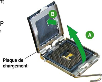
5. Placez le CPU sur le socket de sorte que le triangle doré repose sur le coin inférieur gauche du socket. L'embout d'alignement doit s'insérer dans l'encoche du CPU.
