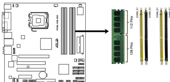
Sockets DIMM DDR et DDR2 de la P5B-VM DO
