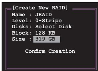
5. 終了したら、<Enter> を押し RAID 設定を確定すると、ダイアログボックスが表示されます。<Y> で確定です。
