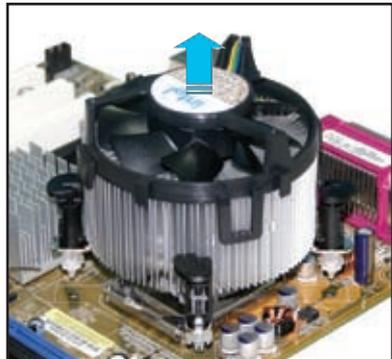
5. 再び取り付ける際には、ファスナーを右方向に回し、ファスナーの方向が正しいことを確認します。
