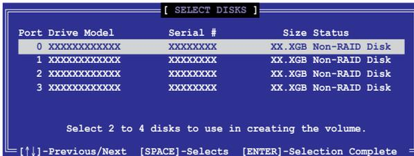
5. 请使用向上、向下方向键来选择硬盘设备，确认后请按空格键选定。接着被选定的硬盘设备旁便会出现一个小三角形图标。当所有要进行阵列设置的硬盘设备选择完毕后，请按下 <Enter> 键。
