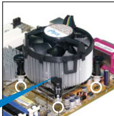
Loch am Motherboard Druckstift
