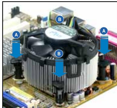
3. 當風扇、散熱片以及支撐機構都已安裝完畢，接著請將風扇的電源線接到主機板上標示有「CPU\_FAN」的電源插槽。
