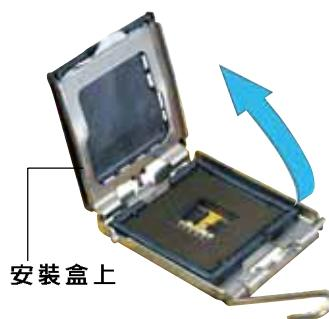
5. 請確認 CPU 的金色三角形標示是位在左下角的位置，接著把 CPU 順著這個方向安裝到主機板的插座上，並請確認 CPU 的左上方的缺口與插座上對應的校準點是相吻合的。
