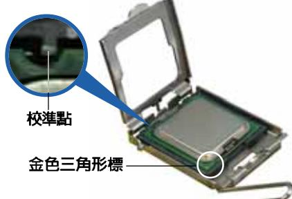
7. 將上蓋重新蓋上 (A) , 接著將固定扳手朝原方向推回並扣於固定扣上 (B) 。
