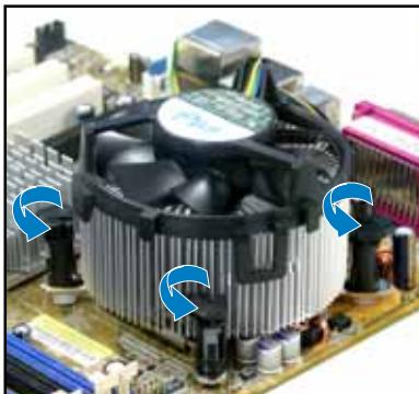
3. 依照順序將扣具扳離主機板上的散熱器插孔，採對角線方式移除，例如：先移除 A，再移除 B；或是先移除 B，再移除 A。
