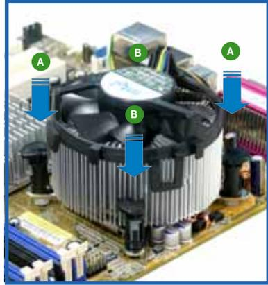
3. 當風扇、散熱片以及支撐機構都已安裝完畢，接著請將風扇的電源線插到主機板上標示有「CPU\_FAN」的電源插座。
