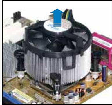
5. 將每個扣具上的旋鈕重新朝順時鐘方向轉回原位。
