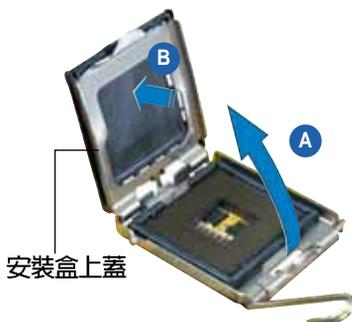
5. 請確認 CPU 的金色三角形標示是位在左下角的位置，接著把 CPU 順著這個方向安裝到主機板的插座上，並請確認 CPU 的左上方的缺口與插座上對應的校準點是相吻合的。
