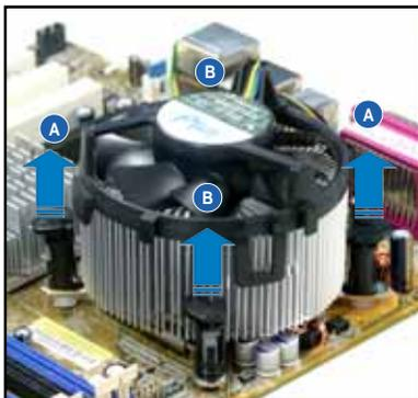
4. 將散熱器與散熱風扇自主機板上移除。
