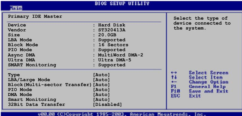
在畫面中出現的各個欄位 (Device、Vendor、Size、LBA Mode、Block Mode、PIO Mode、Async DMA、Ultra DMA 與 SMART monitoring) 的數值皆為 BIOS 程式自動偵測裝置而得。若欄位顯示為 N/A，代表沒有裝置連接於此系統。
