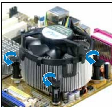
3. 依照順序將扣具扳離主機板上的散熱器插孔，採對角線方式移除，先移除 A，再移除 B（或先移除 B，再移除 A）。
