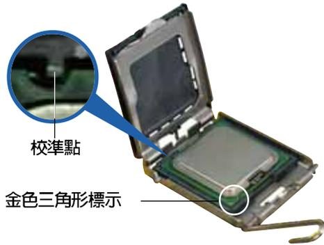
6. 將上蓋重新蓋上，接著請將固定扳手朝原方向推回，並扣於固定扣之上。
