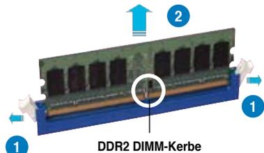
2. Entfernen Sie das DIMM-Modul vom Steckplatz.
