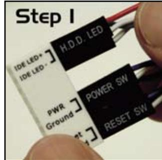
2. Verbinden Sie den ASUS Q-Connector mit dem Systemtafelanschluss.
