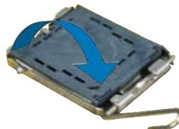
4. Heben Sie die Deckplatte mit dem Daumen und dem Zeigefinger bis zu einem Winkel von 100 Grad an (A). Drücken Sie die PnP-Abdeckung von der Deckplattenaussparung, um sie zu entfernen (B).
