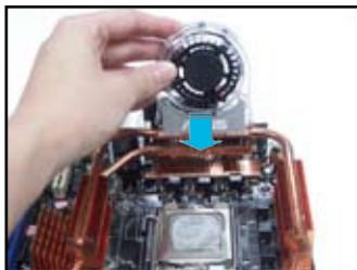
1. Positionieren Sie den Lüfter über der Rohr-Kühlkörper-Gruppe.
