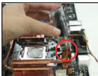
2. Befestigen Sie die geriffelte Kante am Kühlkörper.
