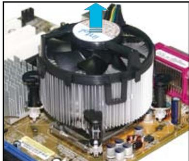
5. Drehen Sie jeden Druckstift im Uhrzeigersinn, um eine richtige Ausrichtung bei Neuinstallation sicherzustellen.
