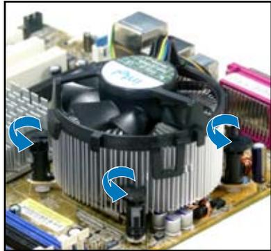
3. Ziehen Sie jeweils zwei Druckstifte diagonal nach oben heraus, um die Kühlkörper-Lüfter-Einheit von dem Motherboard zu lösen.
