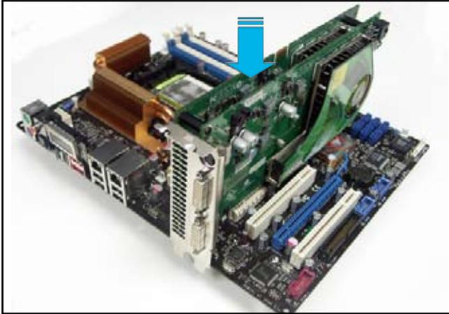
4. Stecken Sie die zweite Grafikkarte in den anderen Steckplatz (PCIEX16\_3). Vergewissern Sie sich, dass die Karte korrekt eingesteckt ist.
