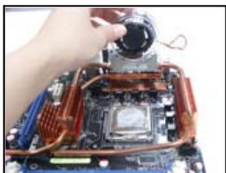
3. Drücken Sie den Lüfter vorsichtig herunter, bis er auf dem Kühlkörper aufsitzt, und befestigen Sie dann das Lüfterkabel.
