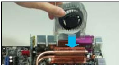
1. 將靜音風扇組裝於如上圖中之熱導管與散熱器的上方。
