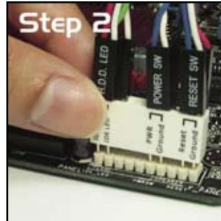
3. 前面板功能已啟動。圖為 Q-Connector 正確安裝至系統插座上的示意圖。
