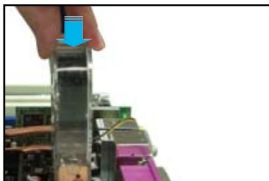
3. 輕輕地壓下風扇使其與散熱器緊密接合，接著連接風扇的電線。
