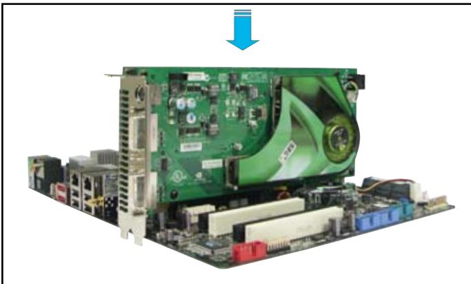
4. 接著將第二張 PCI Express™ 介面顯示卡安裝到標示有 PCIE16\_2 的 第二組 PCI Express x16 介面插槽中。並確認顯示卡已緊密地安裝至插槽中。
