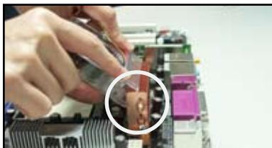
2. 將溝槽的邊緣對準散熱器。
