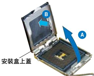
5. 請確認 CPU 的金色三角形標示是位在左下角的位置，接著把 CPU 順著這個方向安裝到主機板的插槽上，並請確認 CPU 的左上方的缺口與插槽上對應的校準點是相吻合的。
