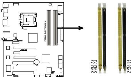
P5N32-SLI PREMIUM 240-pin DDR2 DIMM sockets
