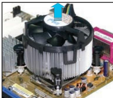
5. 再び取り付ける際には、ファスナーを右方向に回し、ファスナーの方向が正しいことを確認します。
