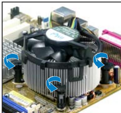
3. 対角線上の2つのファスナーを同時に引き抜いて、マザーボードからヒートシンクとファンを外します。
