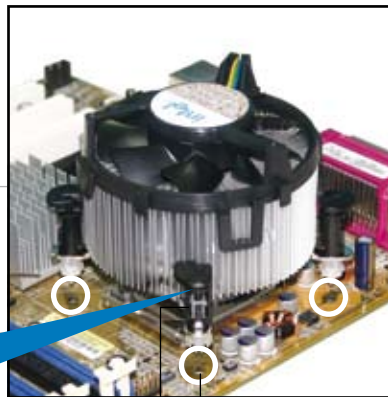
Loch am Motherboard Druckstift
