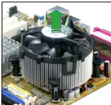
5. Tournez chaque mécanisme de serrage dans le sens des aiguilles d'une montre pour avoir une bonne orientation lors d'une ré-installation.
