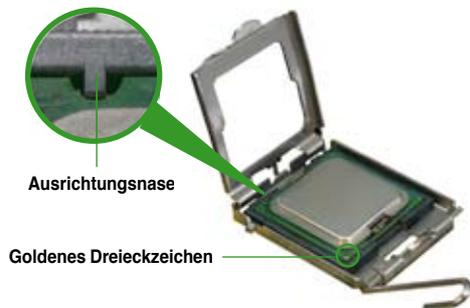
6. Klappen Sie die Deckplatte zu (A) und drücken dann den Arretierhebel (B), bis er in den Halteriegel einrastet.
