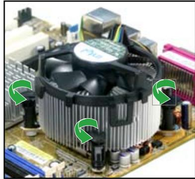
3. Ziehen Sie jeweils zwei Druckstifte diagonal nach oben heraus, um die Kühlkörper-Lüfter-Einheit von dem Motherboard zu lösen.
