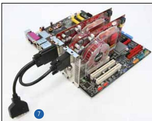
7. 連接這頭尚未連接至顯示器訊號線接頭的插座至顯示器的訊號線上面。
