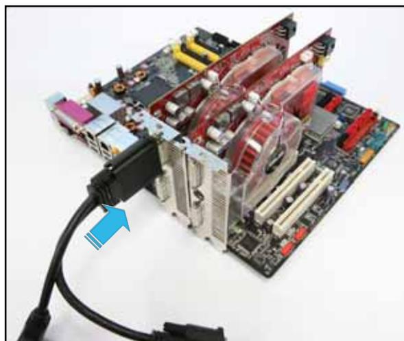
6. 然後將外接排線另一頭連接至子顯示卡 (Slave 端) 輸出接頭上。
