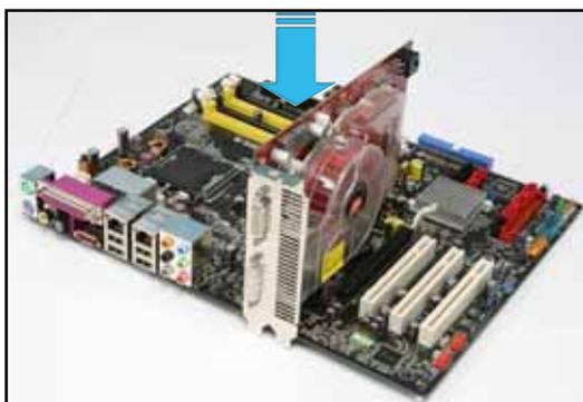
3. 再將支援 CrossFire 的子顯示卡 (Slave 端)，安裝到 PCI Express X16 黑色的顯示卡介面插槽中，並確認顯示卡已緊密地安裝至插槽中。
