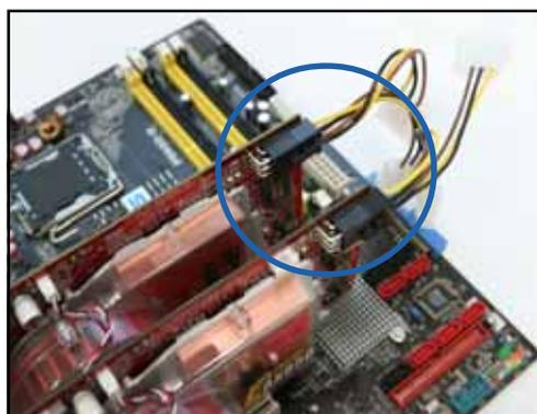
5. 將外接排線連接至母顯示卡 (Master 端) 輸出接頭上。
