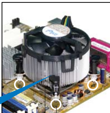
主機板孔位 散熱器與風扇的下推式固定扣具
