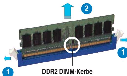
2. Entfernen Sie das DIMM-Modul vom Steckplatz.
