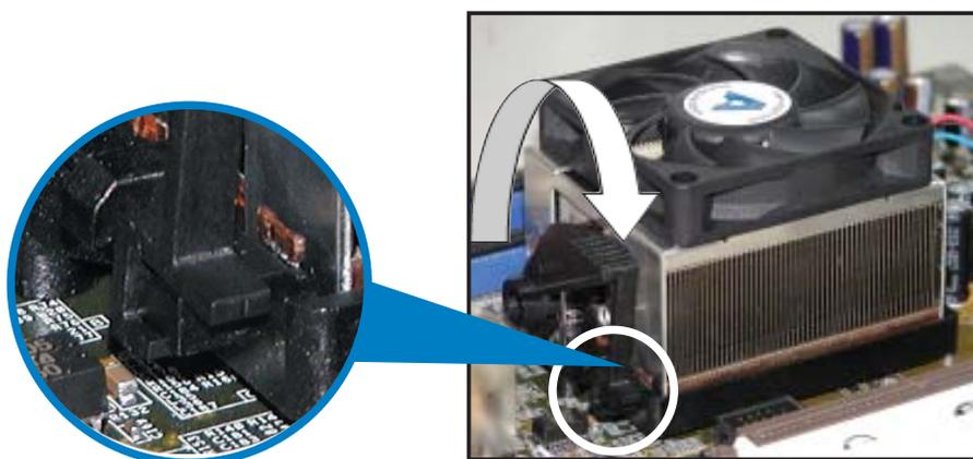
5. Wenn Kühlkörper und Lüfter installiert sind, verbinden Sie das CPU-Lüfterkabel mit dem CPU\_FAN-Anschluss auf dem Motherboard.
