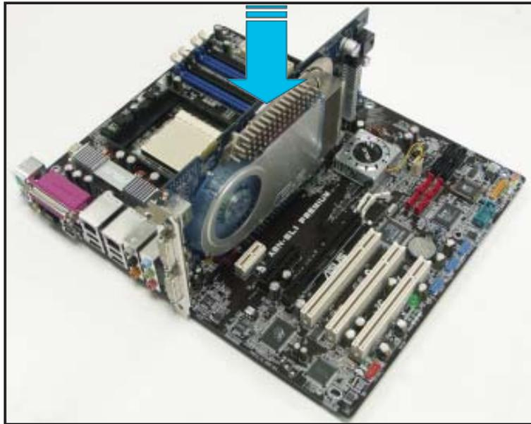
4. Stecken Sie die zweite Grafikkarte in den schwarzen Steckplatz namens **PCIEX16\_2**. Vergewissern Sie sich, dass die Karte korrekt eingesteckt ist.
