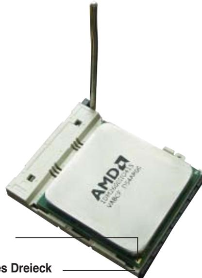
5. Wenn die CPU eingesteckt ist, drücken Sie den Sockelhebel herunter, um die CPU zu fixieren. Der Hebel rastet mit einem Klicken an der Seite ein, wenn er korrekt heruntergedrückt wurde.
