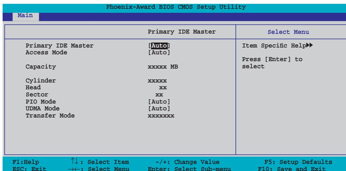
Die Werte neben den mit gedämpfter Farbe dargestellten Elementen (Capacity, Cylinder, Head, Sector and Transfer Mode). werden vom BIOS automatisch ermittelt und sind nicht vom Benutzer einstellbar. "N/A" wird angezeigt, wenn kein IDE-Gerät in diesem System installiert wurde.
