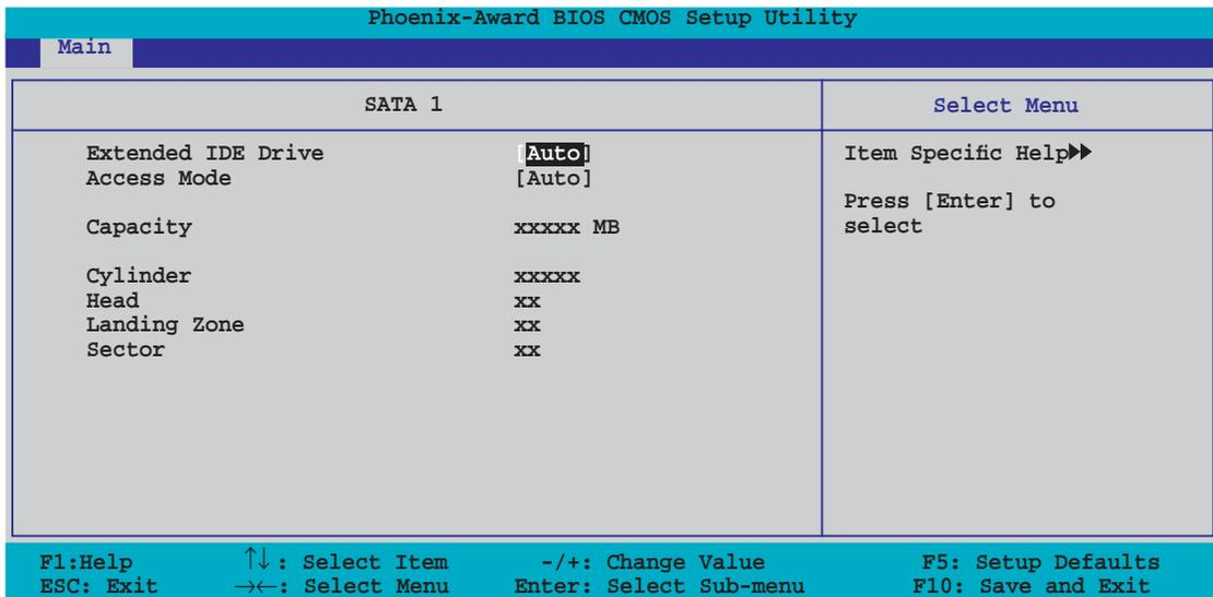
Die Werte neben den mit gedämpfter Farbe dargestellten Elementen (Capacity, Cylinder, Head, Precomp, Landing Zone and Sector) werden vom BIOS automatisch ermittelt und sind nicht vom Benutzer einstellbar. "N/A" wird angezeigt, wenn kein SATA-Gerät in diesem System installiert wurde.
