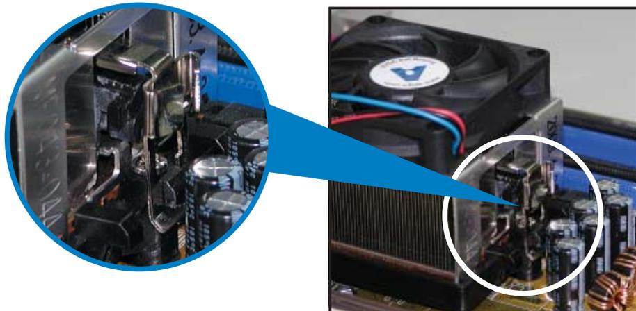
3. Platzieren Sie das andere Ende der Befestigungsklammer (nahe des Hebels) mit dem Befestigungsmodul. Ein Klickgeräusch ertönt, wenn die Befestigungsklammer korrekt einrastet.
