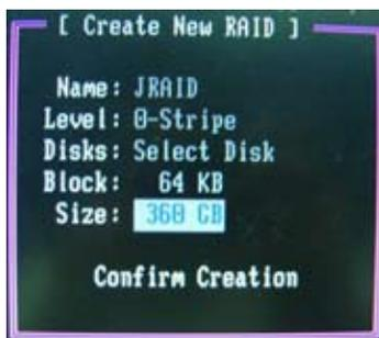
5. 終了したら、<Enter> を押し RAID 設定を確定すると、ダイアログボックスが表示されます。<Y> で確定です。
