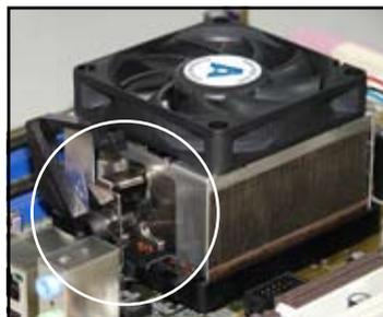
4. 最後再將支撐機構兩側上方的固定拉桿分別拉下鎖住，使得風扇和散熱片能緊密地扣住支撐機構底座。
