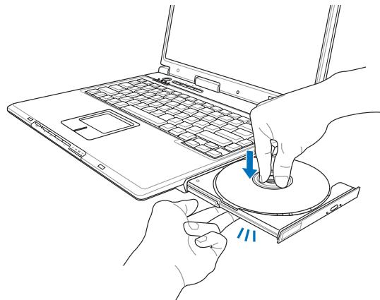
步骤四：一手将光盘轻轻压入托盘定位，另一手请轻扶著托盘。确定光盘置放定位后，再将托盘轻轻推入插槽中。
