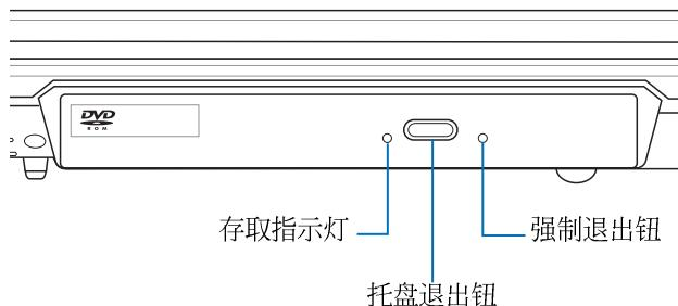
本光驱模块上有一个托盘退出钮（参考上图），托盘退出钮旁边有一个小孔为强制退出钮，当您无法正常打开光驱托盘取出光盘时，可使用一根扳直的回型针插入小孔内退出光驱托盘。当光驱存取中，光驱存取指示灯闪烁，表示光驱正在存取运行中。
