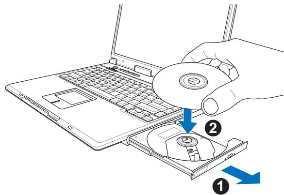
步骤三：将光盘印刷面朝上轻轻置入托盘中央，避免刮伤光盘数据面。
