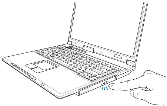
步骤二：请将光驱托盘完全拉出。
