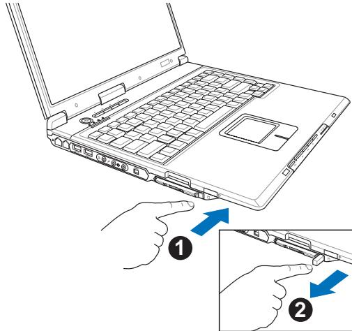
步骤四：再将退出钮向PC卡插槽方向压入，PC卡随即退出。
