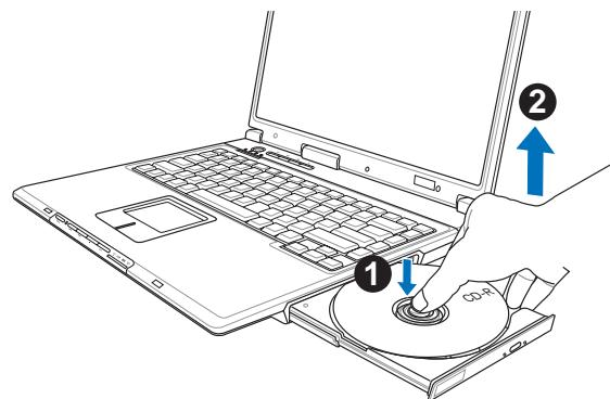
欲取出光盘，使用中指按住光驱托盘中央轴承，食指将光盘边缘向上拨动即可取出。
