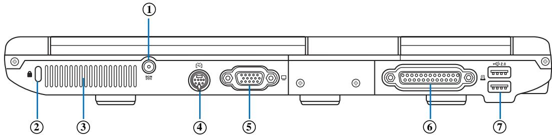
1. 直流电源输入插孔
