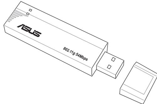
L'adaptateur USB ASUS (WL-167g) est très petit et permet de se connecter aux réseaux sans fil utilisant la norme IEEE 802.11g/b et qui se connecte à l'ordinateur en utilisant un connecteur USB2.0.
