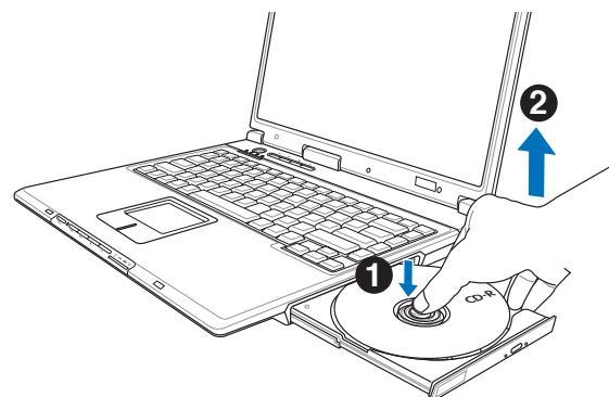
欲取出光盘，使用中指按住光驱托盘中央轴承，食指将光盘边缘向上拨动即可取出。
