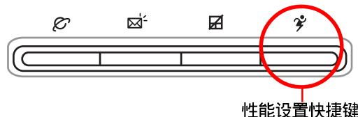
按下快捷键，可在笔记本电脑屏幕左上角直接看到八个不同的图标画面（O S D 在屏显示功能）分别代表八种性能模式，详细说明如下：（以下依最耗电至最节电的顺序排列）
