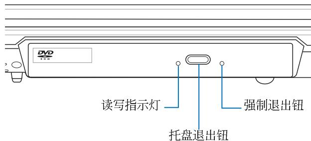
本光驱模块上有一个托盘退出钮（参考上图），托盘退出钮旁边有一个小孔为强制退出钮，当您无法正常打开光驱托盘取出光盘时，可使用一根扳直的回型针插入小孔内退出光驱托盘。当光驱读写中，光驱读写指示灯闪烁，表示光驱正在读写动作中。
