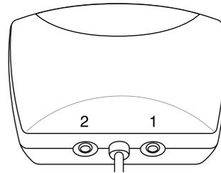
Die Buchsen an der Rückseite des Infrarotempfängers haben derzeit keine Funktion.
